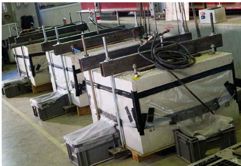
2 | Charge d'eau exercée équivalente à une colonne d'eau de 3 m et contrôle du débit de fuite.
