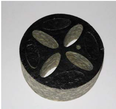
2 | Manchon initialement utilisé derrière les bouches de ventilation du séjour.
