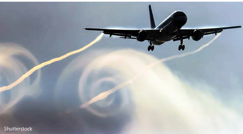
1 | Des tourbillons se forment à l'extrémité des ailes et des ailerons des avions.
