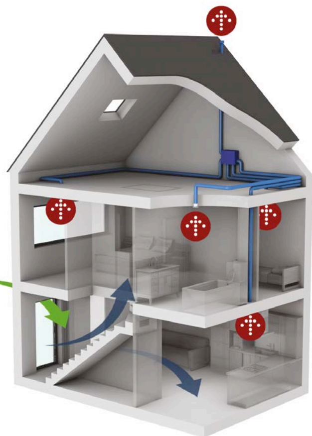
2 | Illustration de la variante basée sur un système C, avec alimentation naturelle via le hall d'entrée.
