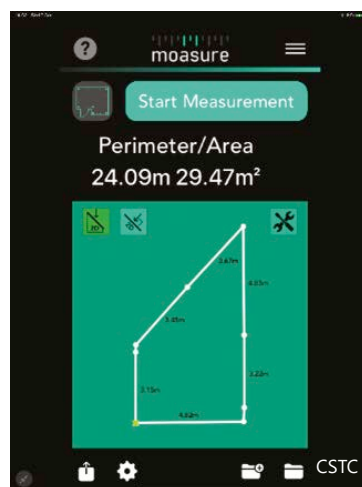
2 | Mesurer et visualiser la surface d'une cour extérieure avec l'application 'Moasure' et son capteur externe (300 $ en 2019).
