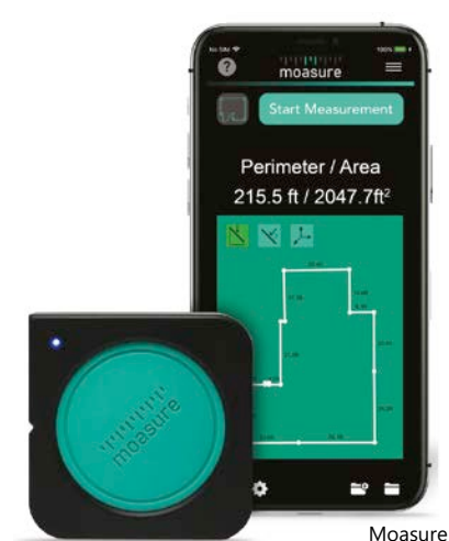
2 | Mesurer et visualiser la surface d'une cour extérieure avec l'application 'Moasure' et son capteur externe (300 $ en 2019).
