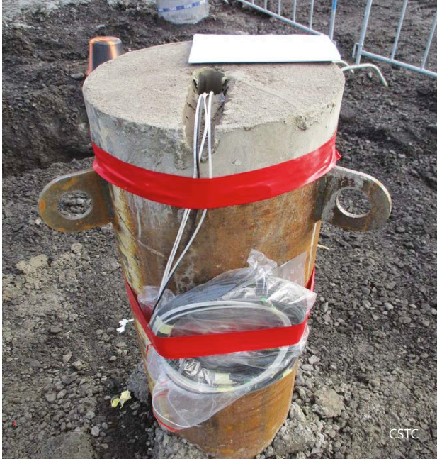
2 | Intégration de capteurs à fibres optiques dans un pieu vissé à refoulement (à gauche) et dans un micropieu (à droite).
