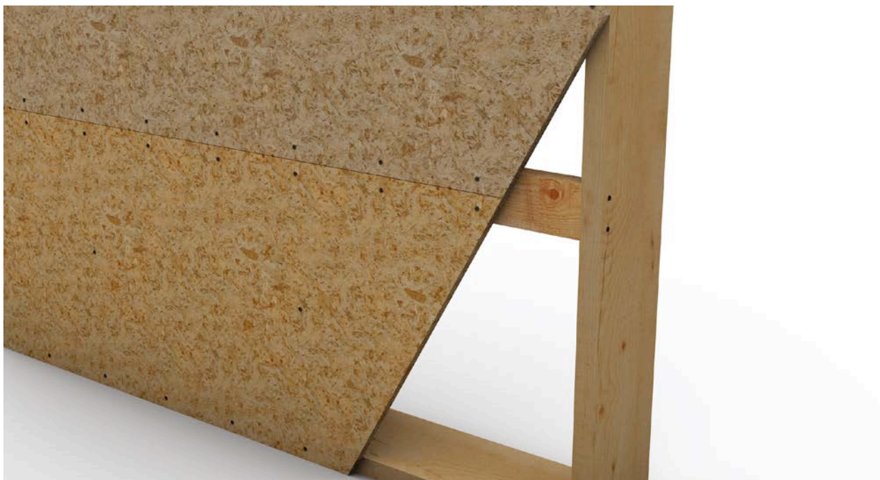
Coutures de liaison mécanique pouvant être réalisées entre des fragments de panneaux découpés.
