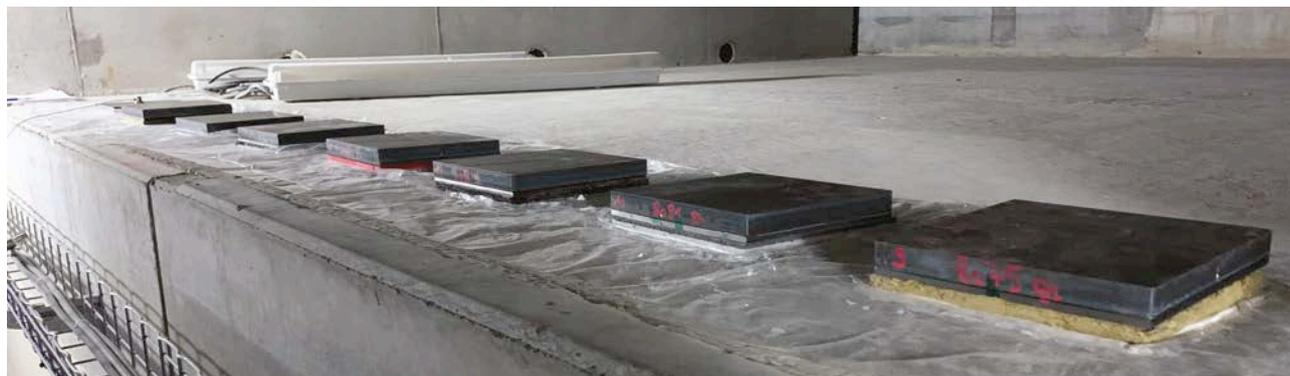
**A** Diminution de la valeur  $\Delta L_w$  pour des sous-couches résilientes soumises à des charges de 200 kg/m<sup>2</sup>.
