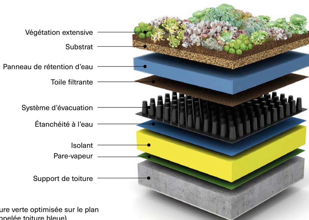
1 Exemple de toiture verte optimisée sur le plan hydrologique (appelée toiture bleue).
