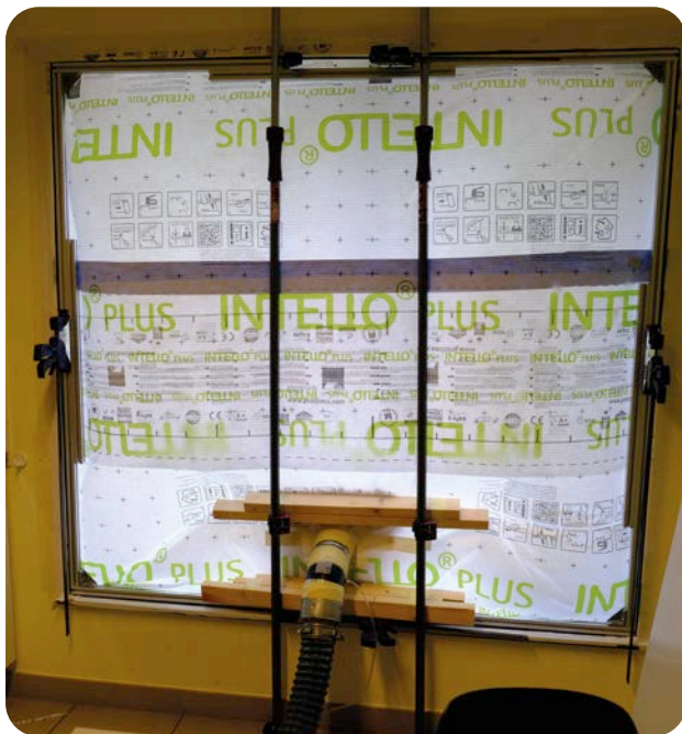
1 In-situmeting van de luchtdichtheid van een raam.
