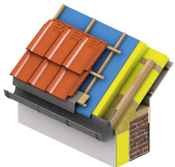
2 Kopers aan de dakvoet.
