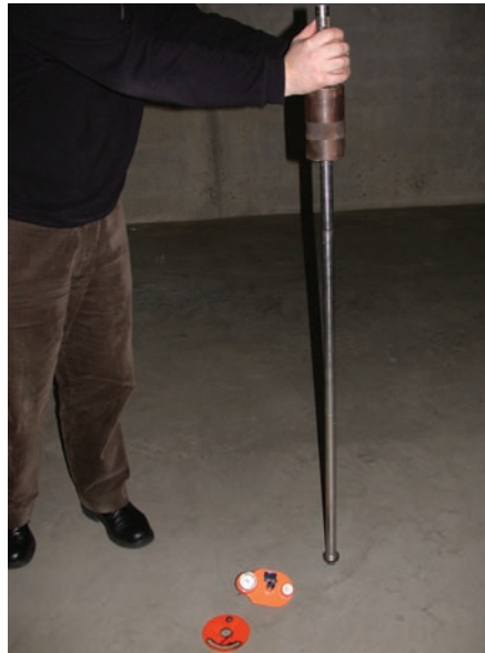
Afb. 3 Uitvoering van de proef met de screed tester (hierboven en hier-naast).
