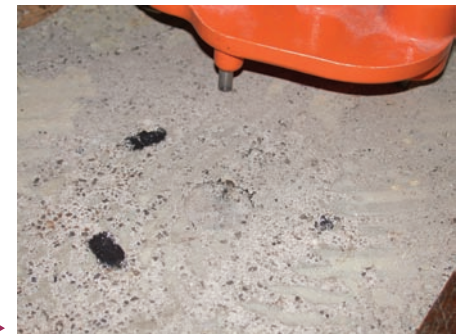
Afb. 3 Uitvoering van de proef met de screed tester (hierboven en hier-naast).
