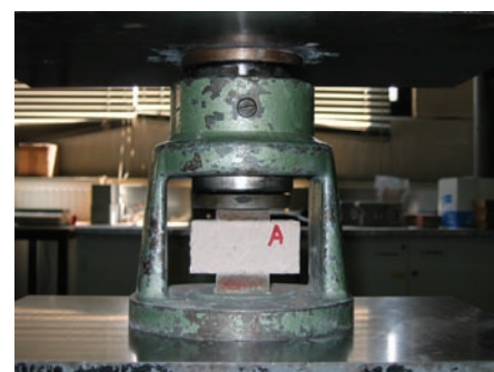
Afb. 1 Druk- en buigtrekproeven op prisma's van 40 x 40 x 160 mm 3 .
