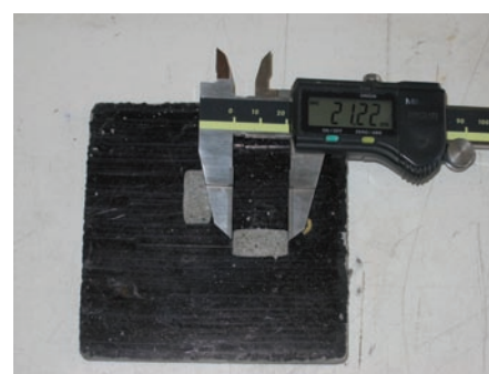
Afb. 4 Bepaling van de koordlengte van de indruk op een proefstuk volgens de norm NBN EN 12808-2.
