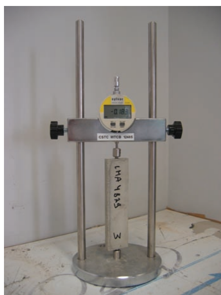
Afb. 2 Bepaling van de vrije krimp op een proefstuk volgens de norm NBN EN 12808-4
