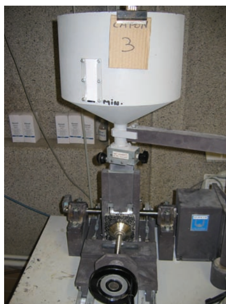
Afb. 3 'Capon'-toestel voor de bepaling van de slijtbestandheid volgens de norm NBN EN 12808-2.
