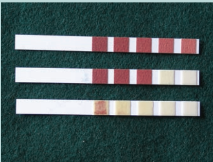
Afb. 13 Vaststellingen op indicatiestrookjes voor sulfaten.
