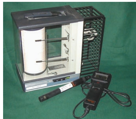
Afb. 4 Voorbeeld van een thermo-hydrograaf.
