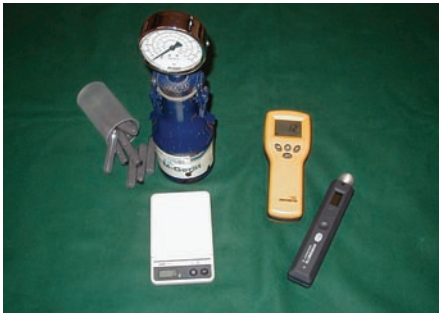
Afb. 6 Toestellen ter bepaling van het vochtgehalte in materialen.
