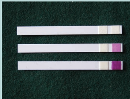
Afb. 14 Vaststellingen op indicatiestrookjes voor nitraten.
