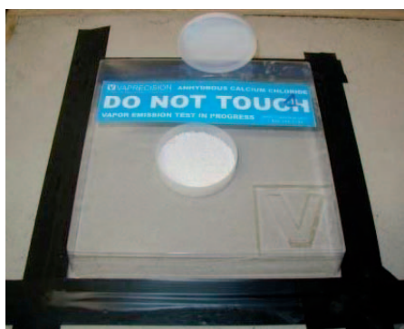
Afb. 11 Proefopstelling van een waterdampemissiemeting.
