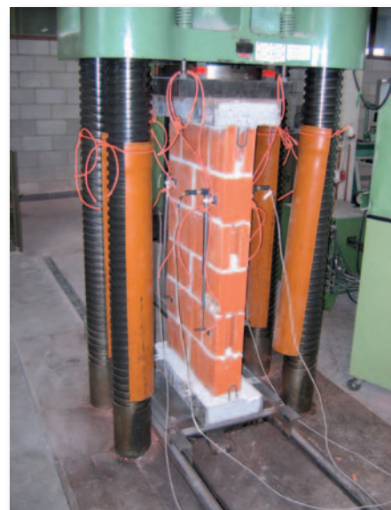
Afb. 3 Drukproef op een muurtje volgens de norm NBN EN 1052-1 [6] (met bepaling van de secans elasticiteitsmodulus ‘E’).
