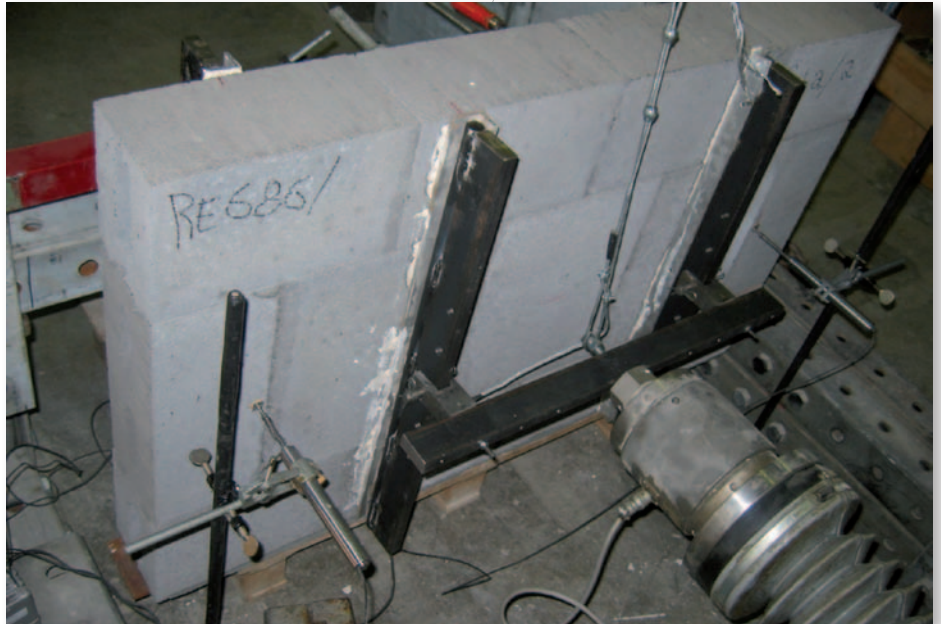
Afb. 6 Bepaling van de loodrechte buigsterkte ( f_{xk2} ) volgens de norm NBN EN 1052-2 [7].
