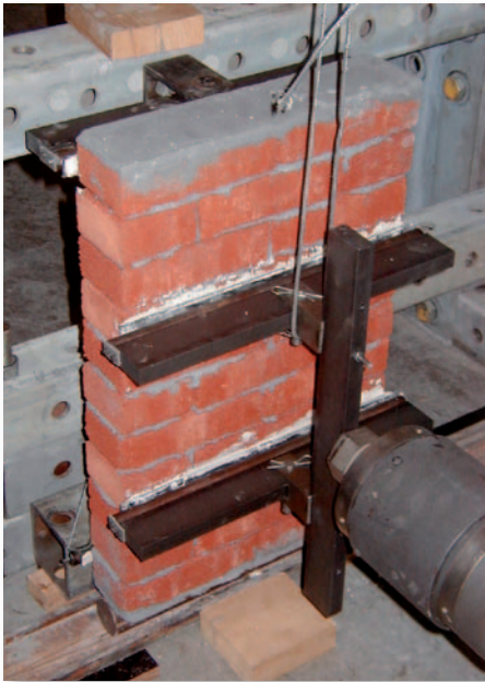
Afb. 5 Bepaling van de parallelle buigsterkte ( f_{xk1} ) volgens de norm NBN EN 1052-2 [7].
