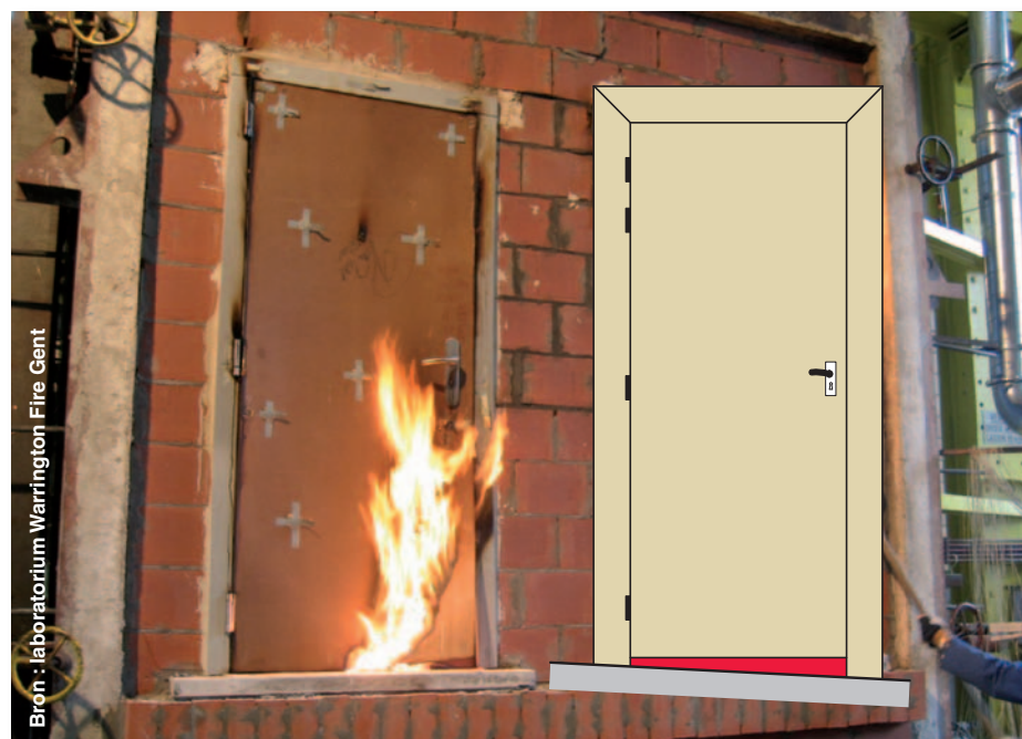
Afb. 1 Horizontaliteits- en/of vlakheidsafwijking in de vloer ter hoogte van de gesloten brandwerende deur en branddoorgang
