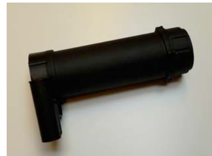
14 | Innovatief toestel dat de stroom kan stabiliseren bij gebruik van een grote vleugelradanemometer.
