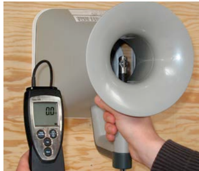
10 | Kleine sonde in combinatie met een specifieke conus.
