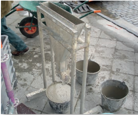
Afb. 2 Vloeibaarheidstest met de V-vormige trechter.
