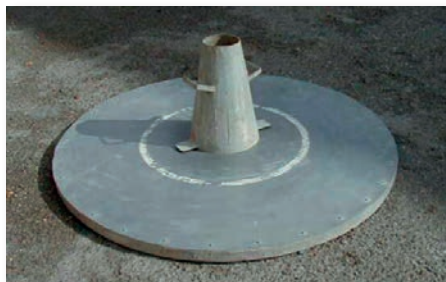
Afb. 1 Meting van de vloeimaat met de Abramskegel ( slump-flow ).
