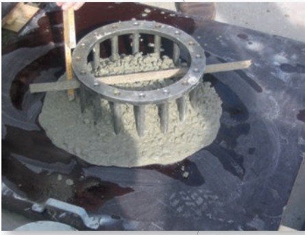
Afb. 5 Test met de ring (J-ring).
