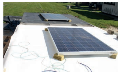
Beoordeling van de invloed van de weerkaatsing van de dakbedekking op de temperatuur van de zonnepanelen
