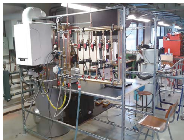
1 | Proefopstelling voor het meten van de SWW-productierendementen volgens het Ecodesignprincipe
