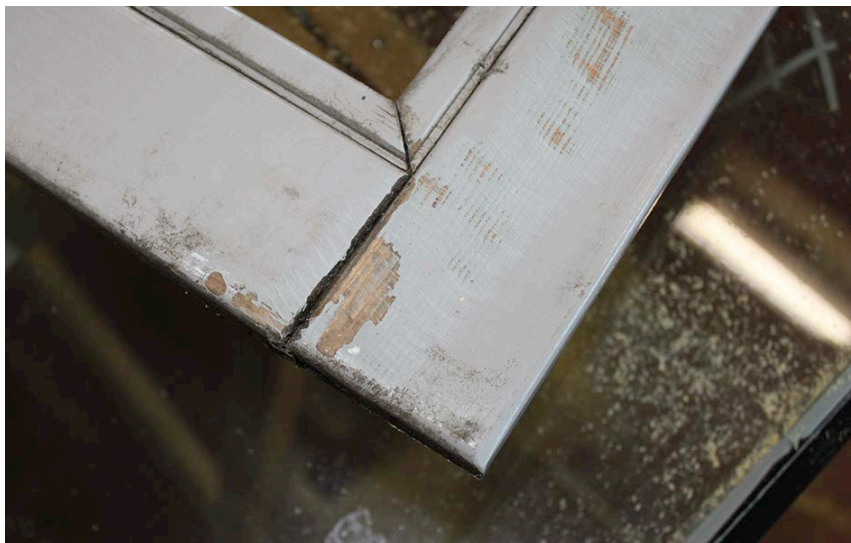
2 | Beschadiging van de hoeken ten gevolge van een niet-optimale verlijming
