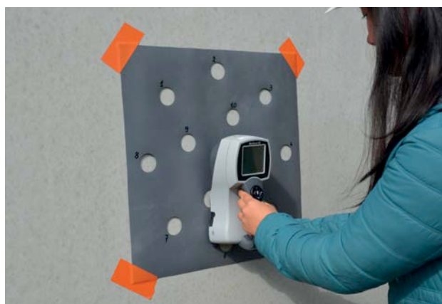
2 | Beoordeling van de tintverschillen met behulp van een kleurmeter en het referentiepatroon uit de norm
