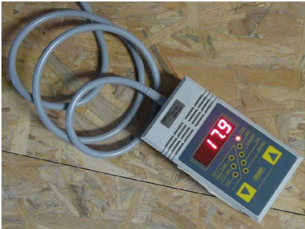
2 | Meting van het opgenomen elektrische vermogen met een vermogensmeter.
