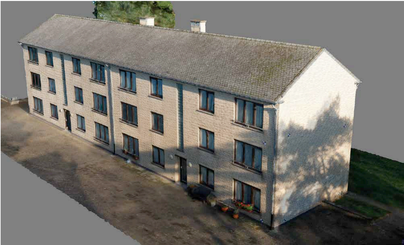
3D-model dat met behulp van een specifieke software gecreëerd werd op basis van een groot aantal genomen foto's.
