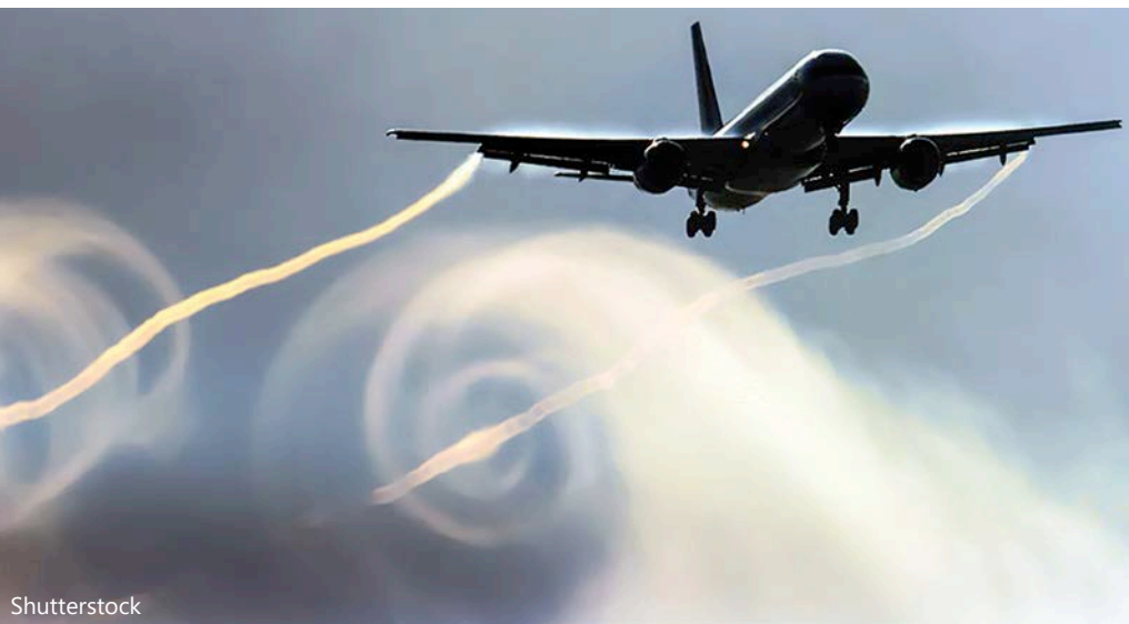
1 | Aan de uiteinden van de vleugels en vleugelkleppen van vliegtuigen ontstaan er wervelwinden.
