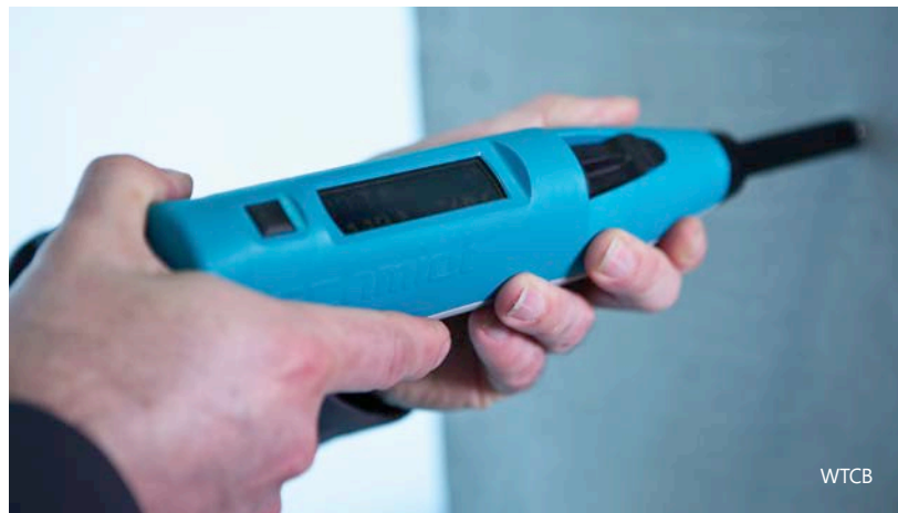
2 | Meting van de terugslagwaarde met behulp van een sclerometer.
