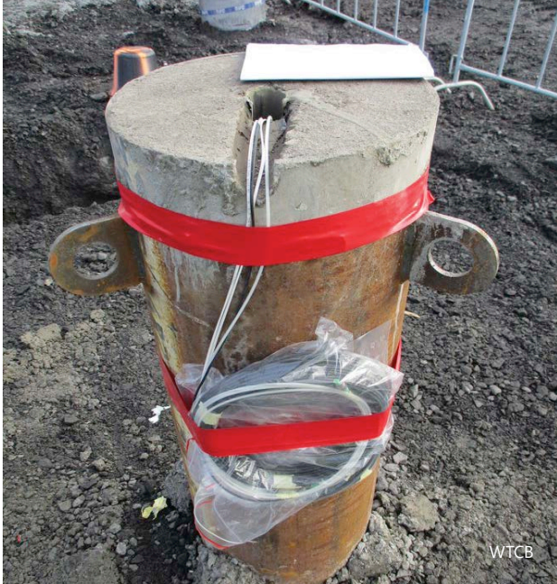
2 | Toepassing van optischevezelsensoren in een grondverdringende schroefpaal (links) en in een micropaal (rechts).
