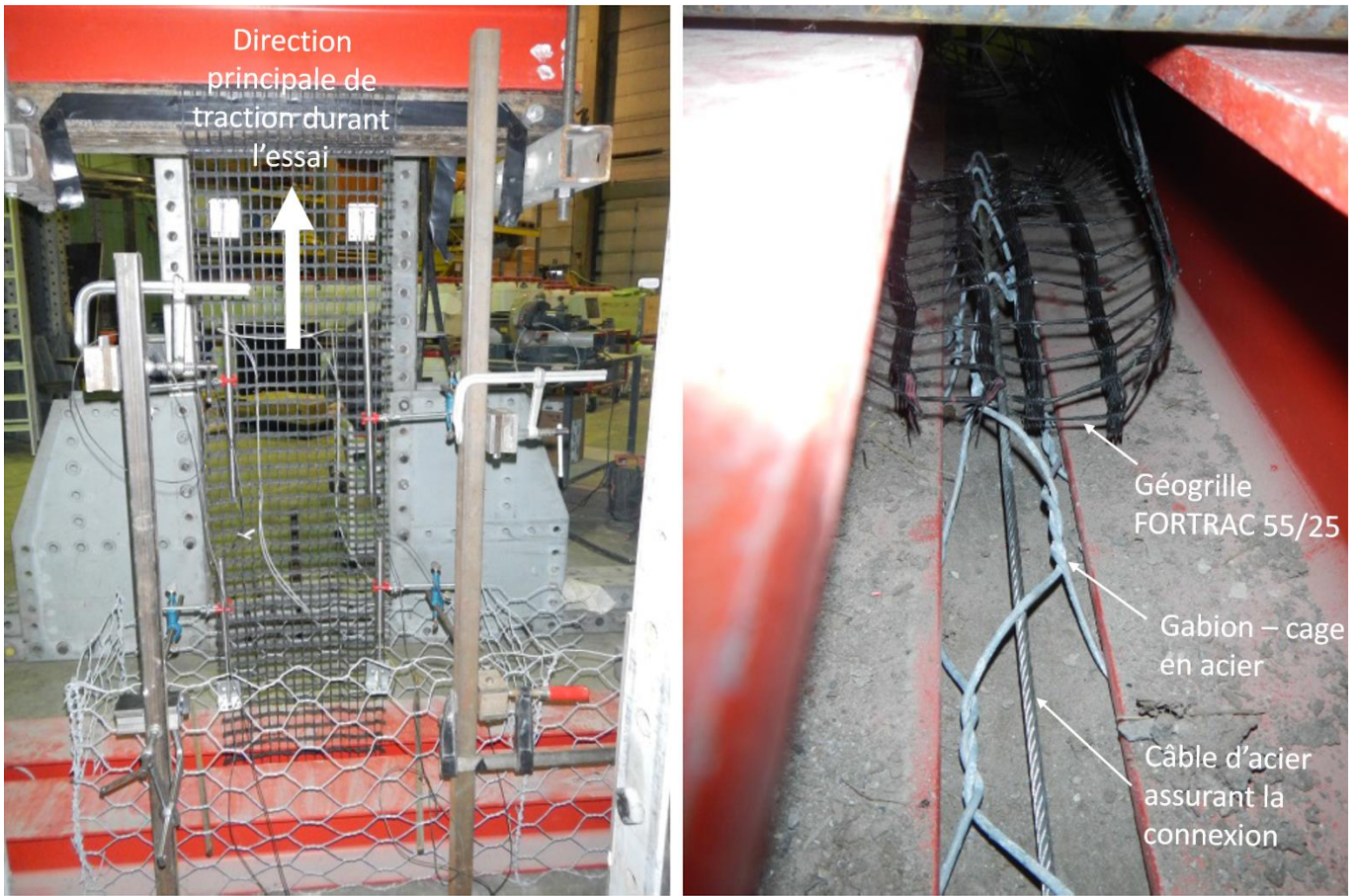
Figure 13. Essai de traction réalisé dans les laboratoires du CSTC de manière à tester la résistance de la connexion « géogridde – gabion ».
