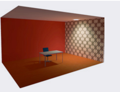
▲ Slechte utilantie: licht op niet-efficiënte manier van verlichtingstoestel naar taakoppervlak
