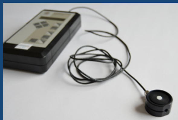
▲ Luxmeter voor het meten van de verlichtingssterkte
